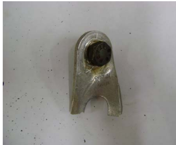
Figura 10- Detalhe da chapeleta "torcida"
