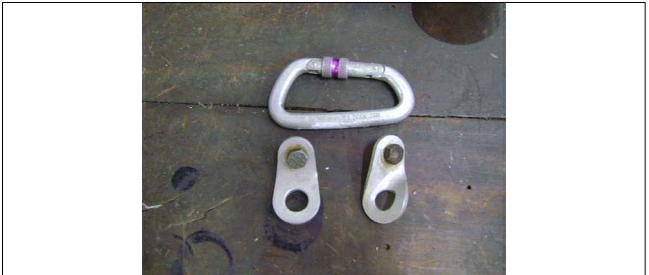
Figura 1: Conjuntos de chapeleta e parafuso como recebidos.
