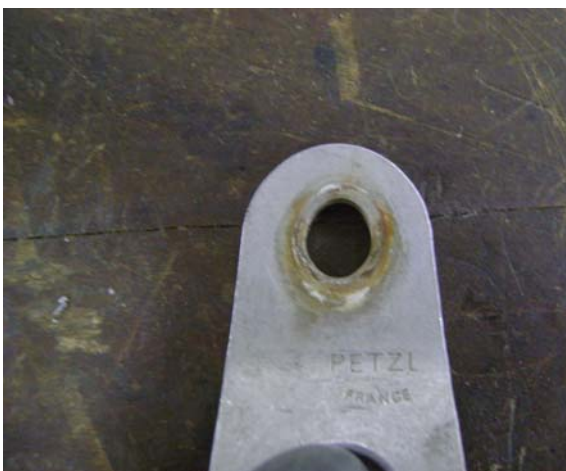
Figura 6- Detalhe da chapeleta após o ensaio, com o furo para o parafuso apresentando deformação.
