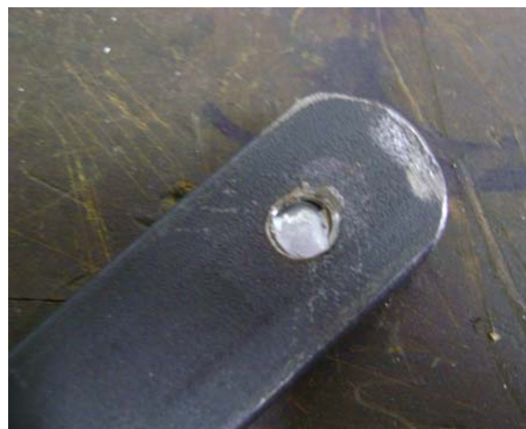
Figura 7- Detalhe do parafuso cisalhado na interface entre o acessório de fixação e a chapeleta.
