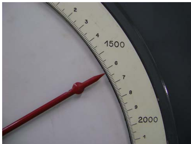
Figura 11- Indicação de carga máxima da máquina de ensaios.
