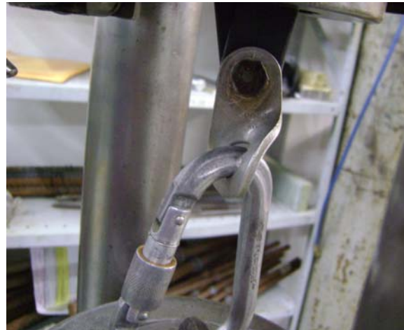
Figura 5: Chapeleta “torcida” sendo tracionada na máquina de ensaios.
