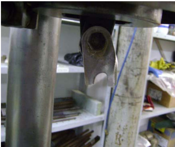
Figura 9- Chapeleta "torcida" após ensaio, fraturada na região do meio do furo.
