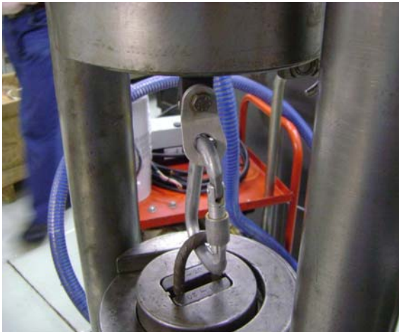
Figura 4: Chapeleta “Reta” sendo tracionada na máquina de ensaios.
